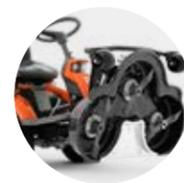
Una unidad de corte limpia permite obtener siempre unos resultados de corte óptimos. La unidad de corte se inclina fácilmente a su posición de servicio para facilitar las tareas de limpieza y mantenimiento
