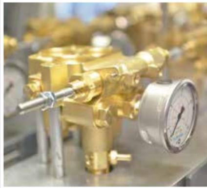
**CABEZAL DE BOMBA DE LATÓN ESPECIAL**
